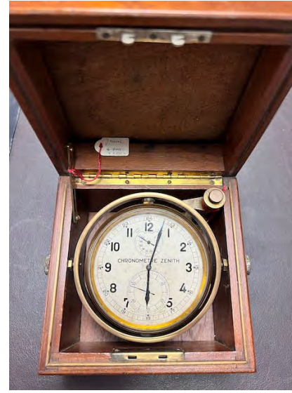
108 | Marinechronometer Zenith, kardanische Werkaufhängung, Aufzug über Lunette. CHF 6'800 jetzt 4'500
