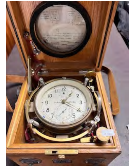
52 | Astronomischer-Flug- Chronometer Russland Mutteruhr "Knopa" Kardanische Federaufhängung, Ankerwerk
